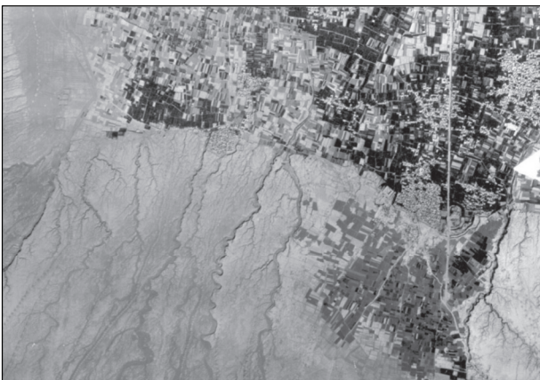
تصویر ۱ - تصویر هوایی بخشی از میبد، پیش از تغییر در شکل پوسته زمین. آبراهه‌ها و بستر رسی (تراس) عرصه جنوبی شهر که امکان مناسب برای پدید آمدن معماری بوکنی است، به خوبی در این عکس پیداست. (ماخذ: سازمان نقشه‌برداری)
